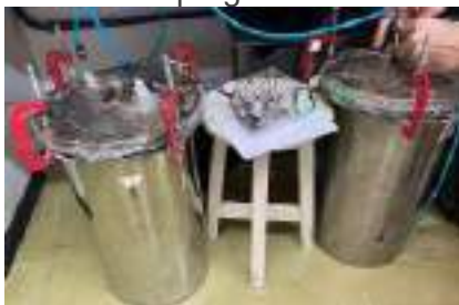
Figura 1. Fotografia dos reatores conectados ao núcleo montado para aquisição de dados de umidade e gráfico da evolução da umidade do lodo (sólido) e do ar (externo). Fonte: autores.
